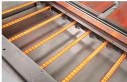
Die Vorheizstrecke wird in 2 Zonen aufgeteilt, deren Längen vom Kunden selbst bestimmt werden können. Optional kann diese Maschine mit einem Pyrometer ausgerüstet werden mit dem man im «closed loop»-Modus die Vorheizung automatisch regulieren lassen kann.
