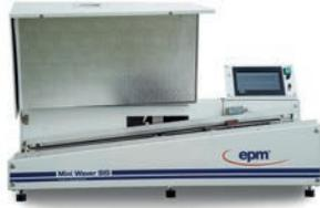
Die MiniWaver SIG überzeugt als Tischwellenlötanlage mit ihrer äußerst robusten Bauweise, der hervorragenden Lötqualität sowie einfachen Nutzung! Diese Lösung ermöglicht Universitäten, Labors oder auch Entwicklern das Testen von Leiterplatten-Designs mit wenig Aufwand und niedrigen Verbrauchswerten.
