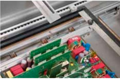
Die **CIG compact SIG** ist eine geschlossene Wellenlötanlage, d.h. eine Vollstickstofflötanlage, die in mittleren bis größeren Produktionen eingesetzt wird. Diese Inline-Anlage kann in eine bestehende Produktionslinie eingebunden werden oder unabhängig von anderen Systemen produzieren. Gleichzeitig bietet EPM die passenden Peripherie-Systeme an. Diese Anlage ist eine Rahmentransportanlage und in drei verschiedenen Breiten (300/400/500) erhältlich.
