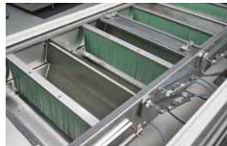
Die Anlage steht komplett (Vorheizbereich, Lötbereich und Ausgangsbereich) unter einer Stickstoffatmosphäre. Diese wird in Echtzeit mittels eines Restsauerstoffmessgerätes überprüft und bei Bedarf automatisch nachgeregelt. Die Nachregelung erfolgt in dem vom Kunden festgelegten PPM-Bereich, in der die Prozesse definiert wurden. Durch das von EPM eingesetzte 5-Schleusensystem (5-Klappensystem) ist die gesamte Anlage in einer homogenen Atmosphäre und der Stickstoffverbrauch ist minimal.
