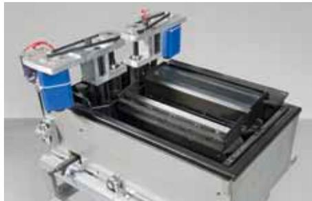
Der Flussmittelauftrag erfolgt gleichmäßig und homogen mittels eines Sprühfluxers. Das gesamte Fluxsystem ist ein geschlossenes und über die Steuerung kontrolliertes System. Die Flussmitteldurchflusskontrolle sowie die -niveauekontrolle sind bei dieser Anlage standardmäßig integriert. Somit stellt die EPM-Anlage einen laufend stabilen Prozess sicher, dies auch in einer 3-Schicht-Produktion.
