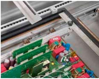
Die **Economy SIG** ist eine offene Wellenlötanlage, die in kleineren bis mittleren Produktionen eingesetzt wird. Diese Inline-Anlage kann in eine bestehende Produktionslinie eingebunden werden oder unabhängig von anderen Systemen produzieren. Gleichzeitig bietet EPM die passenden Peripherie-Systeme an. Diese Anlage ist eine Rahmentransportanlage und in drei verschiedenen Breiten (300/400/500) erhältlich.
