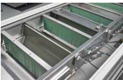
Die Anlage steht komplett (Vorheizbereich, Lötbereich und Ausgangsbereich) unter einer Stickstoffatmosphäre. Diese wird in Echtzeit mittels eines Restsauerstoffmessgerätes überprüft und bei Bedarf automatisch nach-geregelt. Die Nachregelung erfolgt in dem vom Kunden festgelegten PPM-Bereich, in der die Prozesse definiert wurden.
