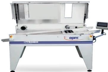
Die Core SIG ist eine kompakte, leistungsstarke und robuste Wellenlötanlage. Sie eignet sich insbesondere für den Einsteigerbereich im Wellenlöten oder für Firmen mit kleinem bis mittelgroßem Produktionsvolumen. Die Swiss-Made Anlage überzeugt mit niedrigen Verbrauchswerten, einer hochwertigen Ausführung und nicht zuletzt auch noch mit ihren hervorragenden und nachhaltigen Lötergebnissen.
