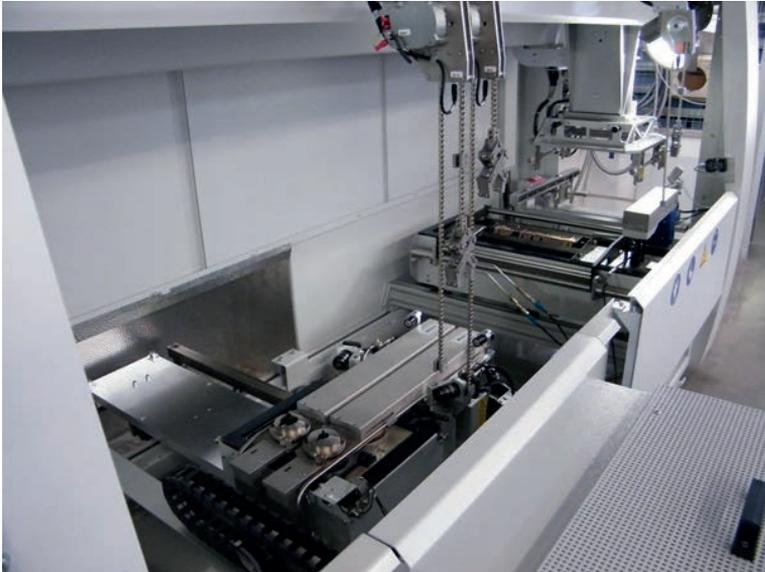
Kombimaschine der Baureihe ELS für Wellen- und Selektives Löten
