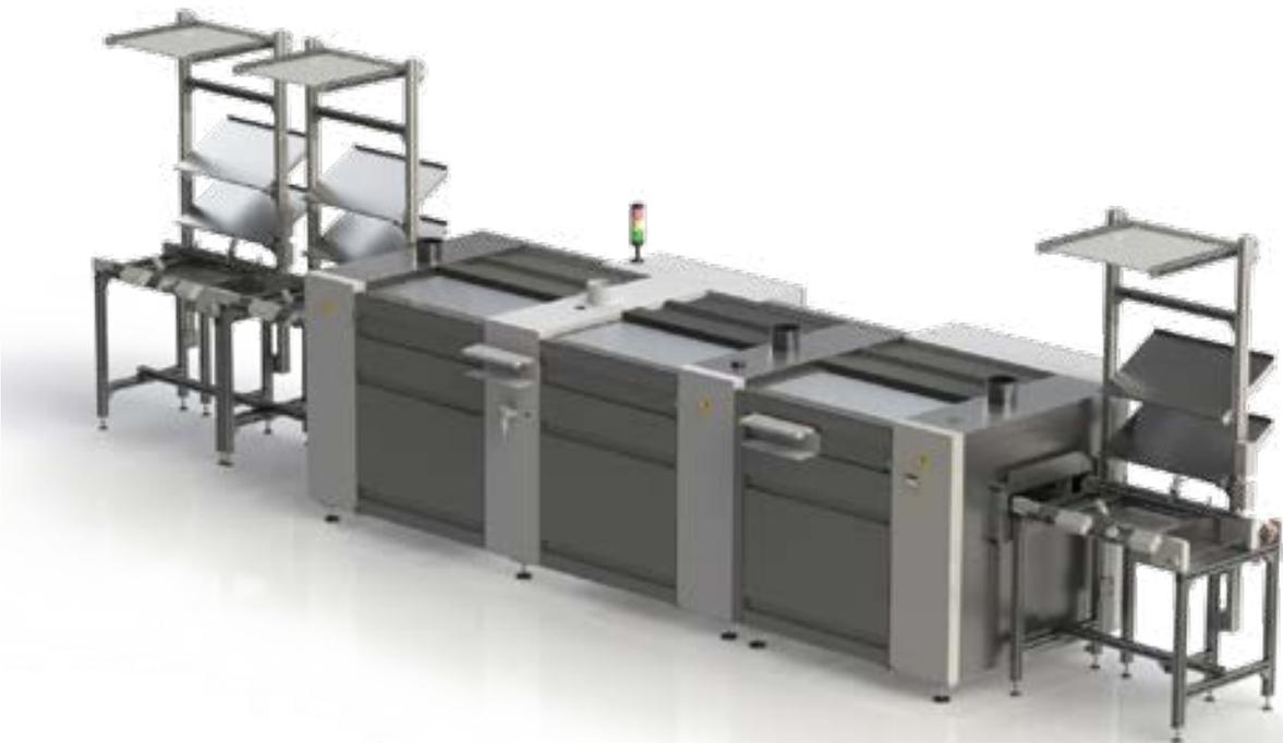
Das AOI direkt im Anschluss an die Lötanlage bietet dem Kunden eine 100%ige Kontrolle der Baugruppe. Durch den nachgeschalteten Verifypplatz kann die Baugruppe nochmals durch den Bediener geprüft, bzw. freigegeben werden.
