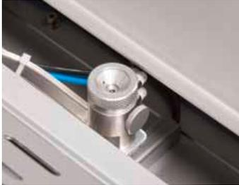
Der Flussmittelauftrag erfolgt gleichmäßig und homogen mittels eines Sprühfluxers. Das gesamte Flussmittelsystem ist ein geschlossenes und über die Steuerung kontrolliertes System. Somit stellt die EPM-Anlage einen stabilen Prozess sicher.
