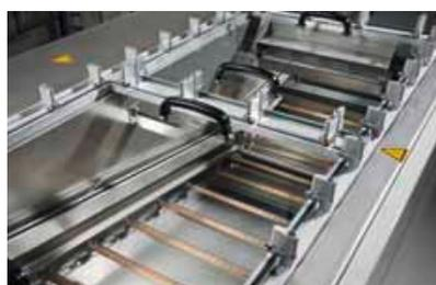
Durch das von EPM eingesetzte 3-Schleusen-system (3-Klappensystem) ist die gesamte Anlage in einer homogenen Atmosphäre und der Stickstoffverbrauch ist minimal.
