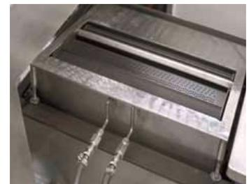
Die Anlage kann mit einer partiellen Stickstoffabdeckung über dem Lötbad ausgerüstet werden. Diese dient insbesondere der Oxidreduktion im bleifreien Prozess.
