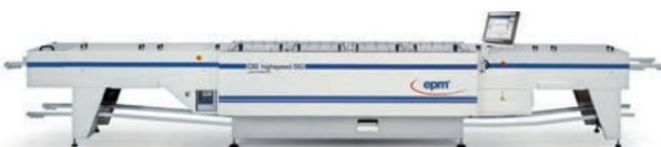
Die CIG Highspeed SIG Vollstickstoff-Wellenlötanlage überzeugt durch hohe Durchlaufgeschwindigkeiten im gesamten Lötprozess. Durch den Einsatz von Stickstoff wird das Prozessfenster vergrößert, die Lötqualität gesteigert sowie der Wartungsaufwand verringert. Die Anlage verfügt über geringe Verbrauchswerte und unterstützt eine nachhaltige und reproduzierbare Produktion.
