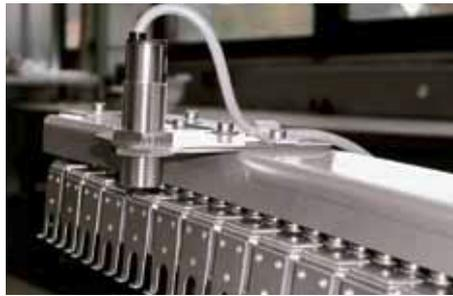
Die **CIG highspeed SIG** ist eine geschlossene Wellenlötanlage, d.h. eine Vollstickstofflötanlage, die in mittleren bis großen Produktionen eingesetzt wird. Diese Inline-Anlage kann in eine bestehende Produktionslinie eingebunden werden oder unabhängig von anderen Systemen produzieren. Gleichzeitig bietet EPM die passenden Peripherie-Systeme an.
