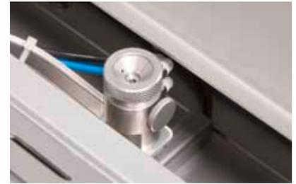
Der Flussmittelauftrag erfolgt gleichmässig und homogen mittels eines Sprühfluxers. Das gesamte Fluxsystem ist ein geschlossenes und über die Steuerung kontrolliertes System. Die Flussmitteldurchflusskontrolle sowie die -niveauekontrolle sind bei dieser Anlage standardmässig integriert. Somit stellt die EPM-Anlage einen laufend stabilen Prozess sicher, dies auch in einer 3-Schicht-Produktion.
